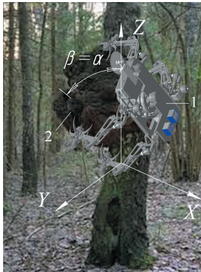
Рис. 4-Б. Положення мобільного робота при обрізці наросту 1– робот; 2 – наріст на дереві
