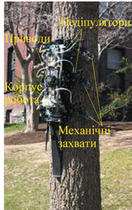
Рис. 6.4. The RiSE Climbing Robot (Boston Dynamics, Cambridge, USA) при переміщенні по дереву і стіні будинку
