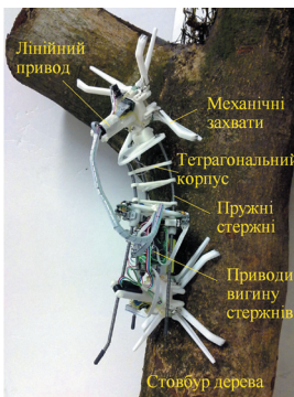
Рис. 6.5. Мобільний робот [13] для обслуговування деревних масивів
