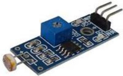
Рисунок 8.2. – Зовнішній вигляд дискретного датчика освітленості на фоторезисторі
