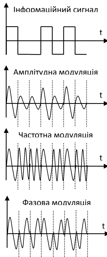
Рис. 15.3. Види модуляції сигналу в лінії зв'язку
