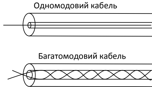
Рис. 14.5. Конструкції оптичних волокон
