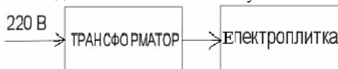
Малюнок 1.1 – Схема електрична структурна підключення електроплитки.
