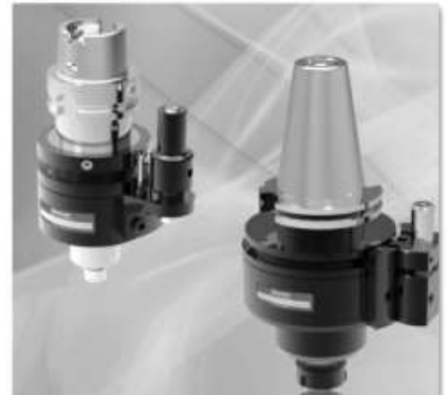
Рис. 6.7 Приклад використання головки з різними хвостовиками
