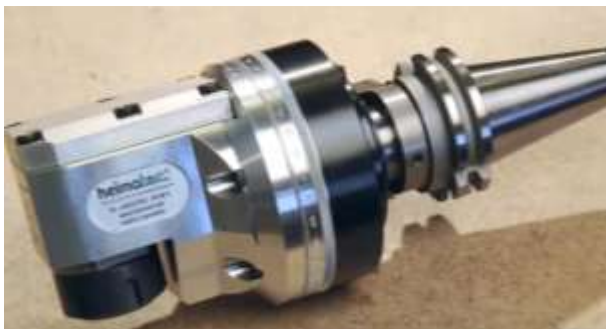
Рис. 6.16 Головка фірми Heimatec та заміна її на верстаті автооператором
