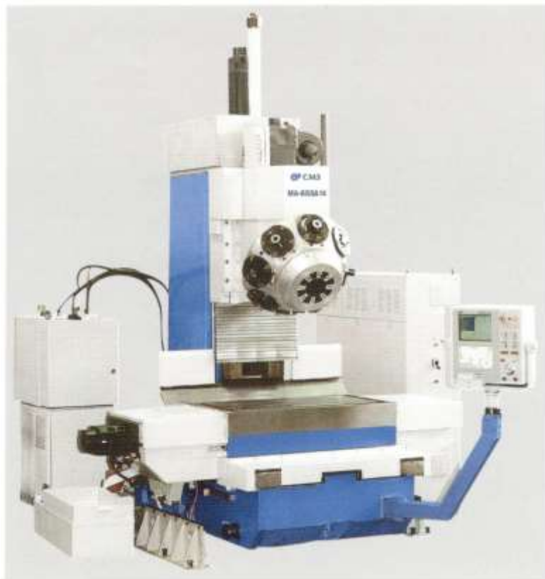
Рис.7.18 Вертикально-фрезерний верстат з ЧПК мод. МА-655А14/ПН (Савеловський машинобудівний завод). Кількість інструментів в магазині – 8. Максимальний діаметр інструмента – 160 мм.
