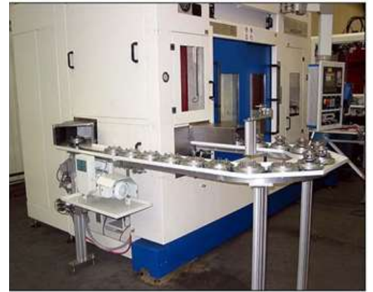
Рис. 8.32 Циркулююча система подачі заготовок та відведення деталей.
