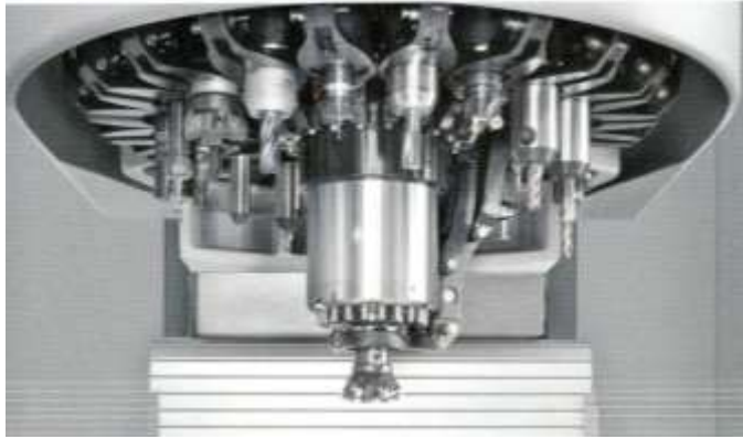
Рис. 7.9 Магазин обробного центру серії FZ12W – FZ12W MAGNUM (Chiron)
