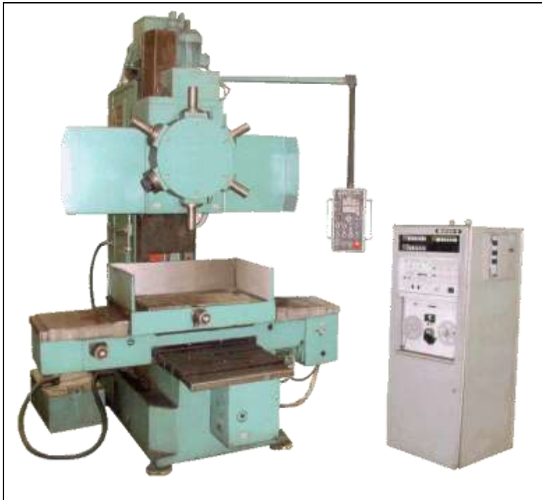
Рис. 7.16 Верстат вертикально свердлильний. 2P135Ф2 з ЧПК, револьверною 6- тишпіндельною головою і хрестовим столом
