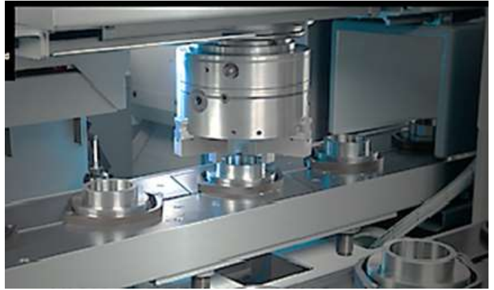
Рис. 8.31 Високошвидкісний верстат із позицією Pick-up для завантаження заготовок.
