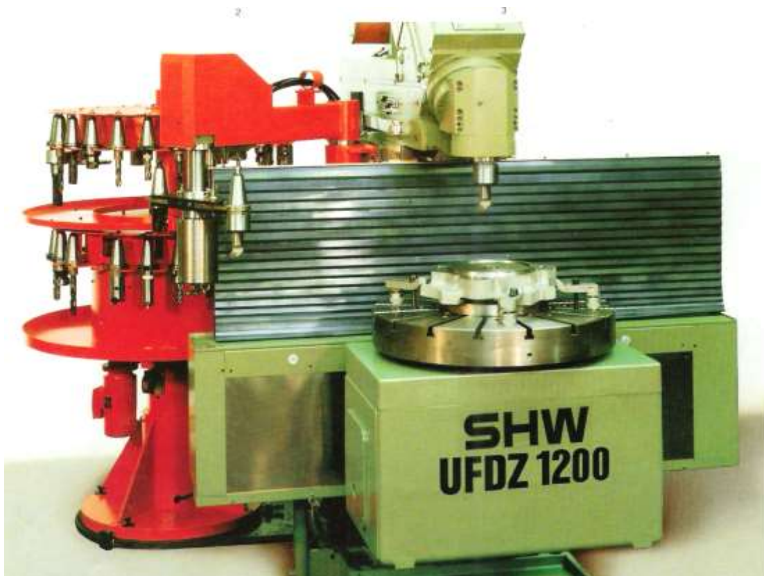
Рис. 7.13 Фрезерно-розточуючий центр UFDZ 1200 фірми SHW: розташування магазину поряд із обробним центром.
