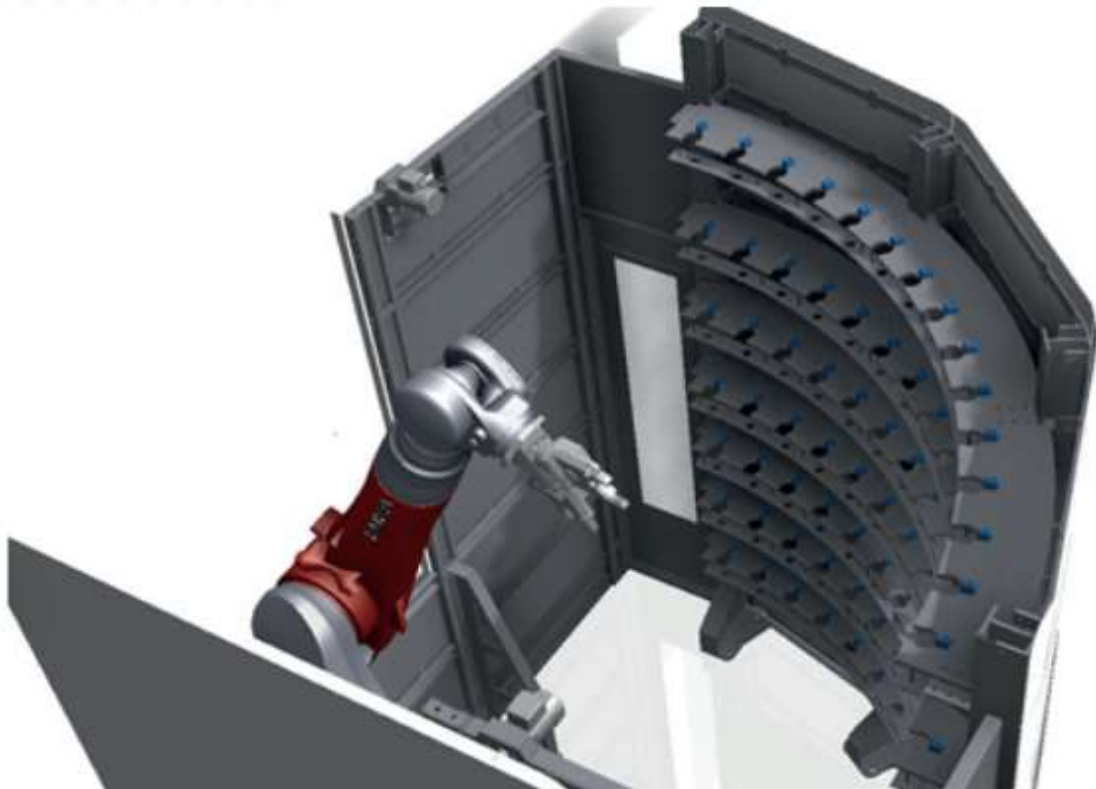
Рис. 7.12 Магазин стележного типу для горизонтально-розточувального верстату: заміна інструментів промисловим роботом з 6-ма осями (компанія Fermat, Чехія)
