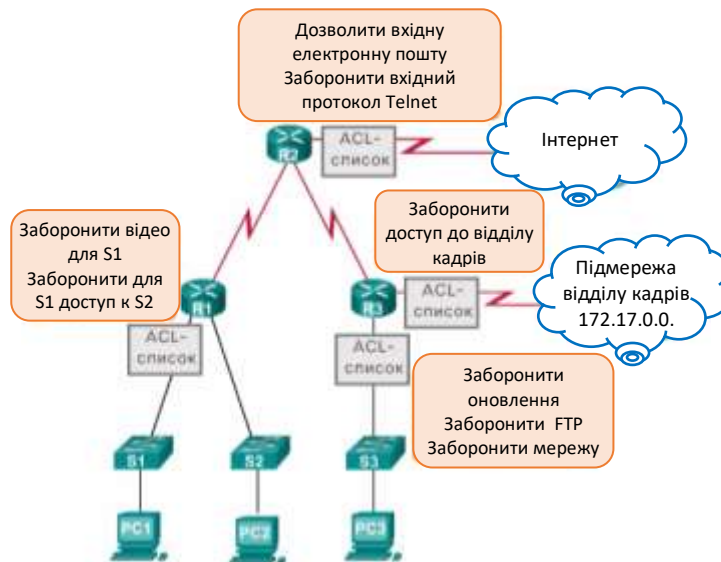
Рисунок 6.1 – Топології з використанням ACL-списків
