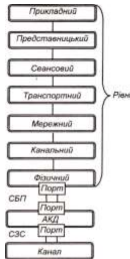
Рисунок 1.5 – Рівні в мережній моделі, запропонованій ISO: СБП – стик блока приєднання; СЗС – стик, що залежить від середовища
