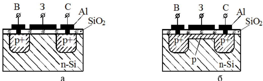
Рисунок 5.3 – Структури польових транзисторів з ізольованими затворами
