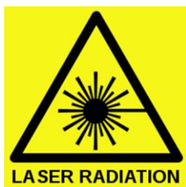
Рис. 7.16. Значок, який має бути на корпусі будь-якого пристрою, в якому є лазер класу 2–4
