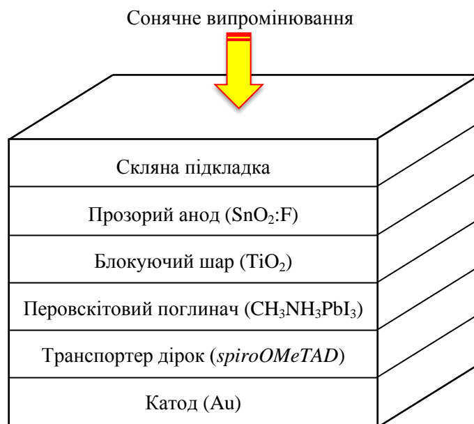
Рис. 3.22. Структура перовскітового сонячного елемента
