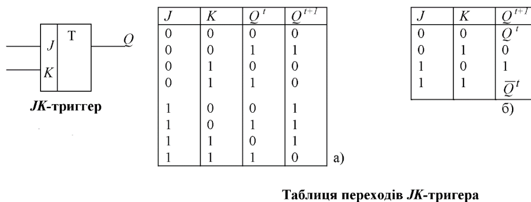
Рис. 9.5 – Умовне позначення і таблиця переходів JK-тригера
