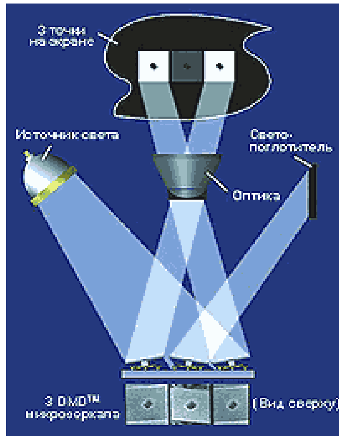
Рис. 4.12. Принцип формування зображення за допомогою DMD-матриці (Digital Micromirror Device)
