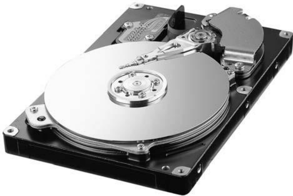
Рис. 5.12. Внутрішній устрій вінчестера SpinPoint P80 Serial ATA виробництва корпорації Samsung
