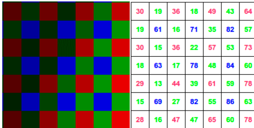
Рис. 6.5. Фрагмент зображення на матриці та його оцифровка у % кольору, як вона сприймається при зчитуванні інформації.
