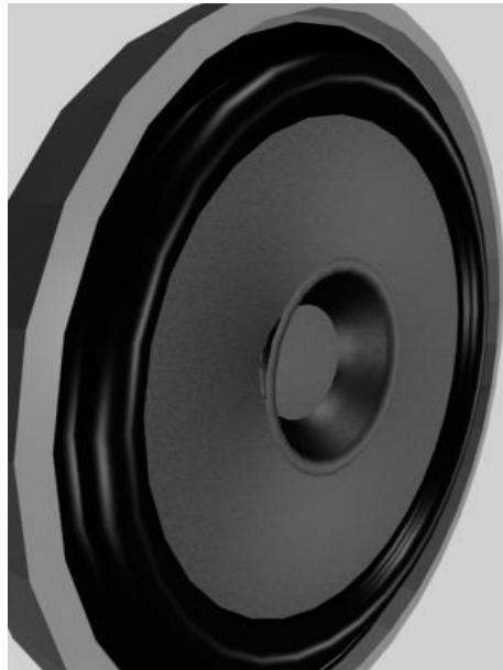
Рис. 4.39. Паперовий дифузор з захисним ковпачком з щільнішого паперу у формі рупора.
