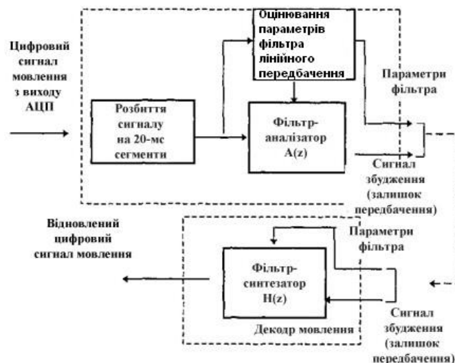
Рисунок 3.4 – Робота кодека мови в методі лінійного передбачення
