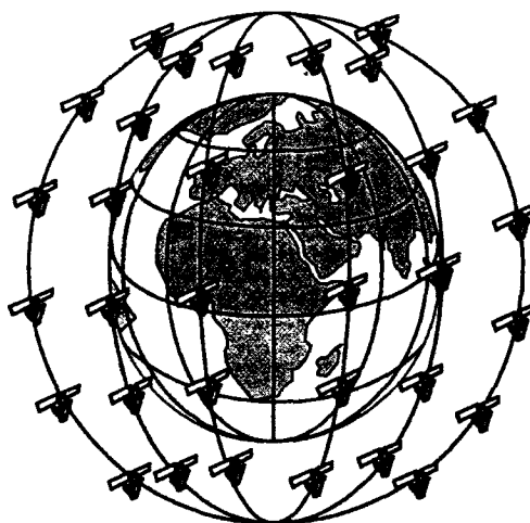
Рисунок 6.4 – Система Iridium: 66 супутників на шести квазіполярних орбітах
