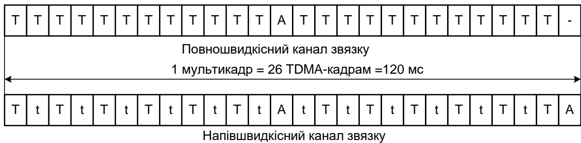
Рисунок 4.9 – Схема об'єднання каналів зв'язку
