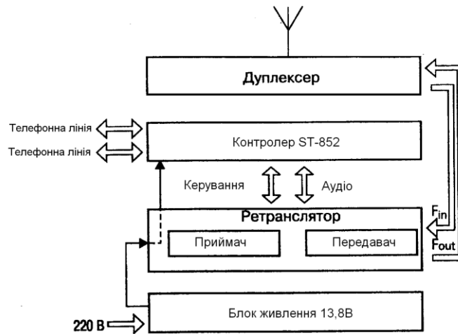
Рисунок 7.5 – Структура одноканальної транкінгової системи
