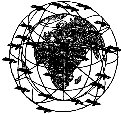
Рисунок 6.6 Система Globalstar – 48 супутників на 8 орбітах
