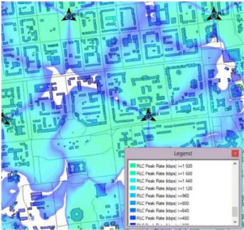
Рисунок 7.5 – Результат моделювання покриття технологією HSDPA
