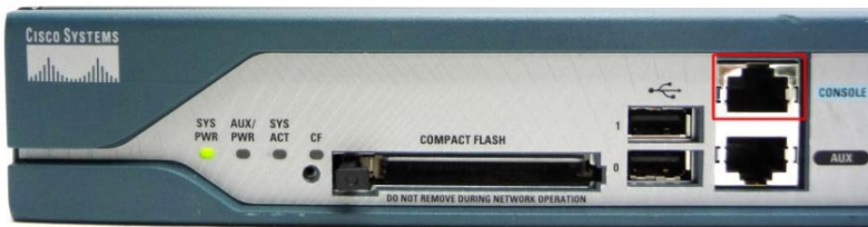
Рисунок 1.3 Консольний порт на маршрутизаторі Cisco 2811
