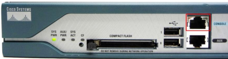
Рис. 2.3. Консольний порт на маршрутизаторі Cisco 2811
