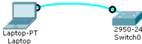
Рис. 2.5. Підключення консольного кабелю в Cisco Packet Tracer
