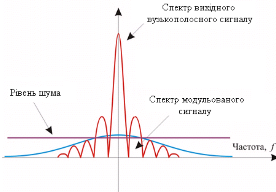
Рисунок 7.1. Використання технології розширення спектру дозволяє передавати дані на рівні природного шуму.
