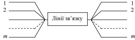
Рисунок 3.8 – Геометрична модель каналу БЧМ
