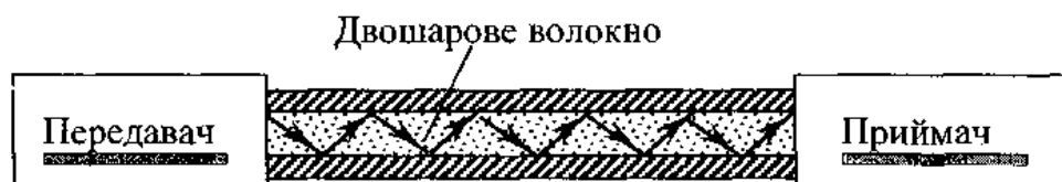
Рис. 8.10. Принцип поширення оптичного випромінювання
