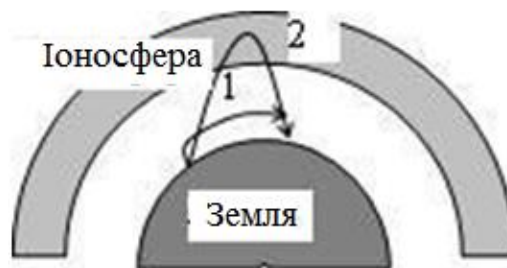
Рис. 9.8. Поширення поверхневих і просторових радіохвиль
