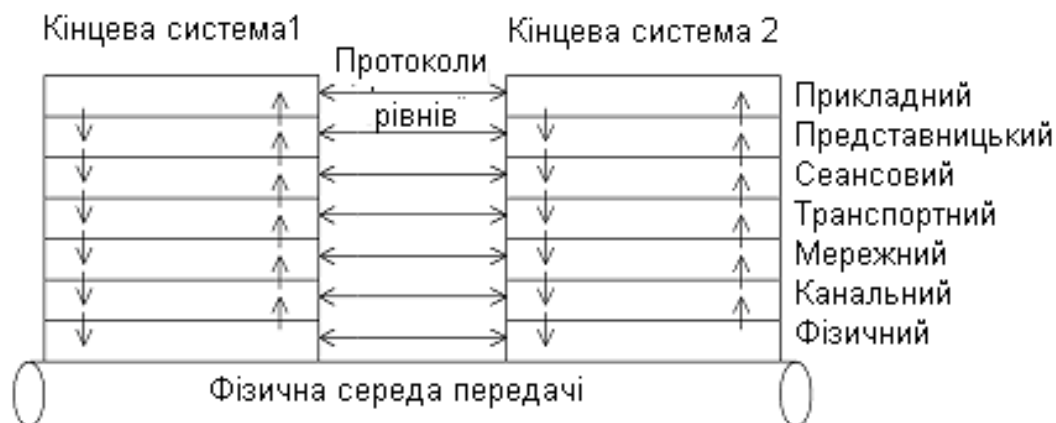
Рисунок 4.1 - Структура моделі OSI
