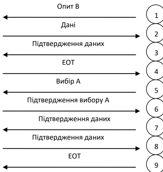
Рисунок 4.7 - Структура системи опиту/вибору з загальним каналом передачі
