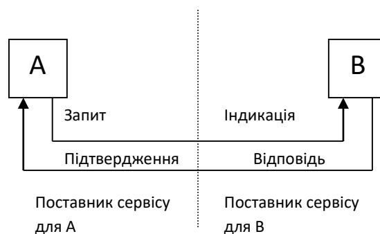
Рисунок 4.2 - Модель взаємодії з встановленням з'єднання
