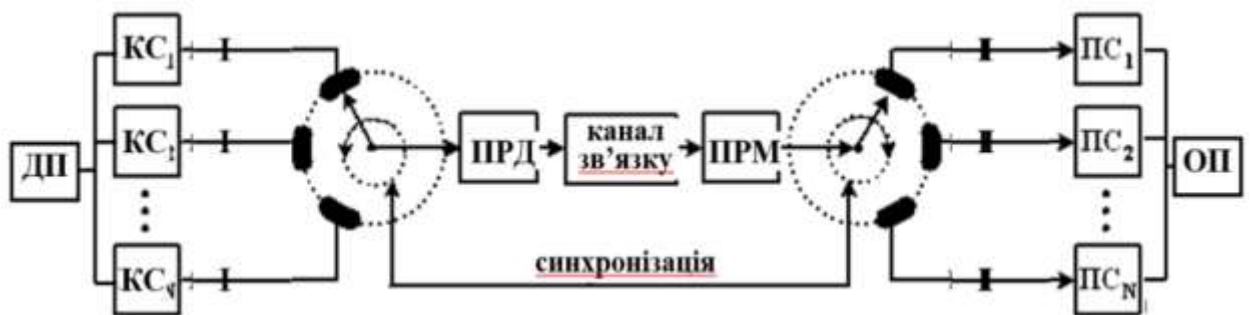
Рисунок 1.3 – Синхронна робота передавальної та приймальної частини СПД
