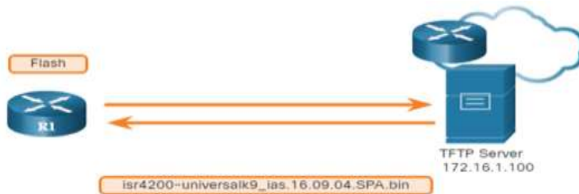
Рисунок 3.15 – Зберігання файлів конфігурації на центральному сервері TFTP
