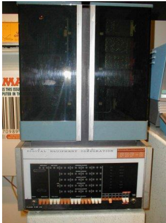
Рисунок 1.4 - Перші комп'ютери на основі транзисторів. Digital Equipment випустили 1965 року перший міні-комп'ютер PDP-8 розміром з холодильник і вартістю всього 20 тис. доларів.
