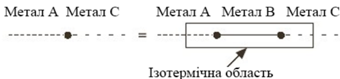
Рисунок 2.36 – Підключення термопари з урахуванням проміжних металевих провідників
