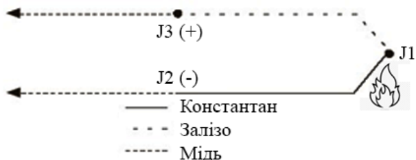
Рисунок 2.34 – Підключення термопари J-типу до ПЗД
