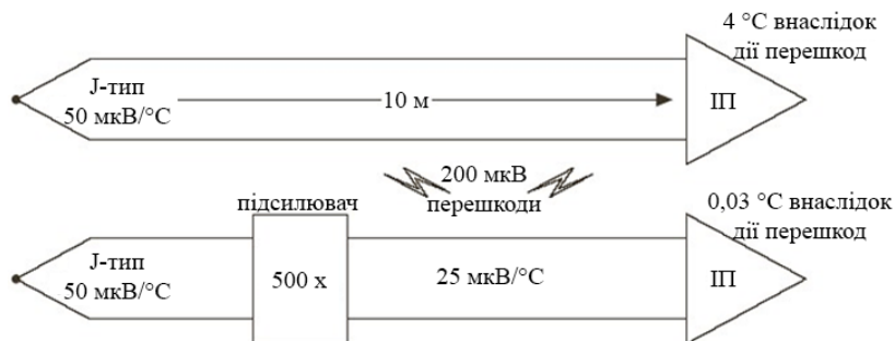
Рисунок 2.29 – Вплив перешкод на сигнал термопар
