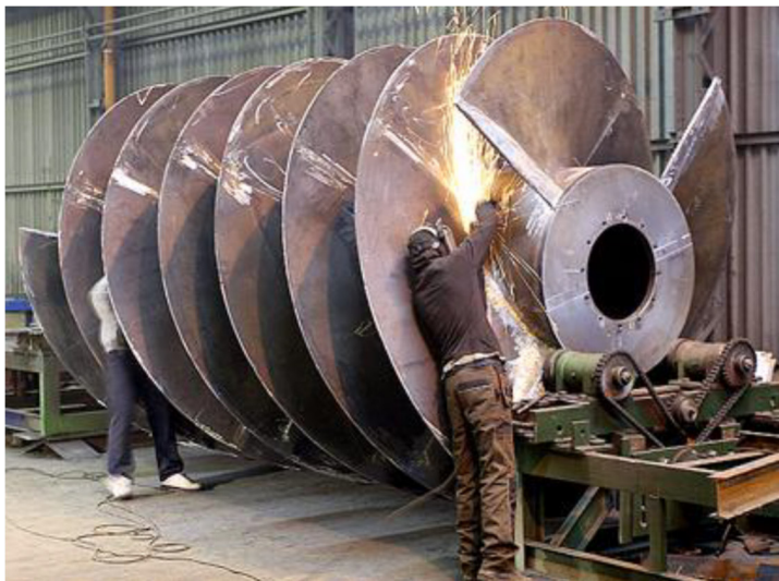
Рис. 5.88. Шнекова гідротурбіна (Archimedes Hydropower) http://hydromew.pl/
