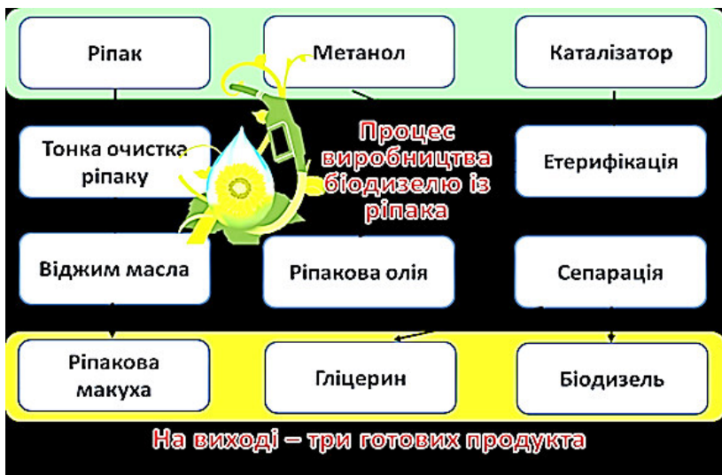
Рис. 6.32. Процес виробництва біодизелю із ріпаку
