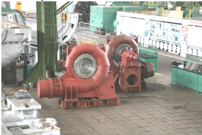
Рис. 5.41. Малі горизонтальні гідротурбіни потужністю 1100 кВт для Шахмарданської ГЕС, ВАТ «Турбоатом» http://www.turboatom.com.ua/ru/press/news/10.html
