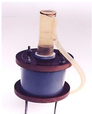
Рис. 7.8. Лабораторна модель низькоамперної комірки електролізера
