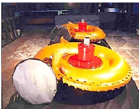
Рис. 5.49. Спірально-осьова гідротурбіна для малої ГЕС виробництва ВАТ «ІНСЕТ», http://aenergy.com.ua/jelektrosnabzhenie/mini-i-mikro-ges.html
