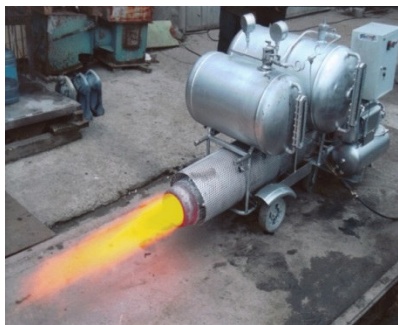
Рис. 7.17. Автоматизована турбогенераторна установка
