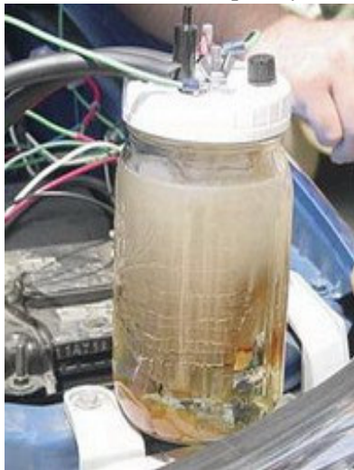
Рис. 7.5. Лабораторна установка з коміркою Мейера
