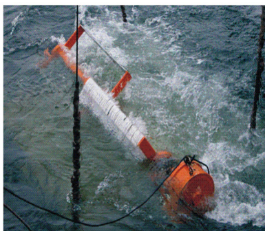
Рис. 5.81. Вільно-потоквова занурена мікроГЕС потужністю 3 кВт, http://www.ideasandmoney.ru/Ppt/Detail
