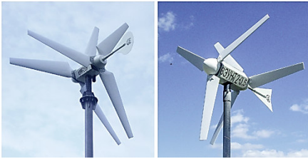
Рис. 4.25. Загальний вигляд дослідних зразків ВЗУНТ 2х0,5 кВт ліворуч – з діаметром вітрових коліс 2,2 м; праворуч – с діаметрами ВК 1,5 м
