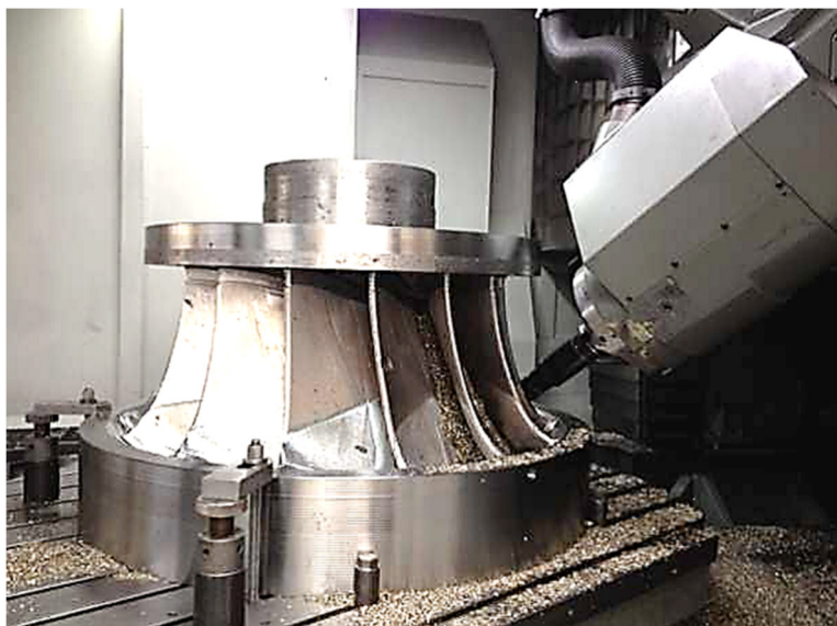
Рис. 5.58. Робоче колесо з поковки гідротурбіни типу Frensis, http://www.business-consortium.ru/energeticheskoe-oborudovanie/gidroturbiny
