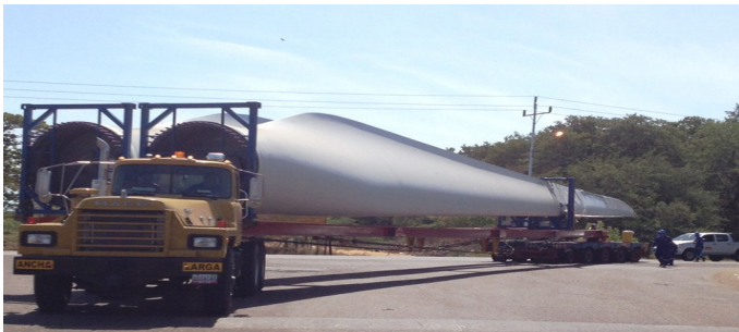
Рис. 4.64. Транспортування лопатей вітрогенератора автотранспортом, Венесуела. http://gruzavtoperevozki.ru/perevozka-negabarita-po-
