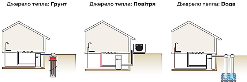
Рис. 3.34. Типи низькопотенційних джерел енергії для теплових насосів
