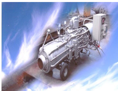
Рис. 7.15. Воднева турбогенераторна установка ВТГУ-2, винахід НППСО «Грантстрой»
