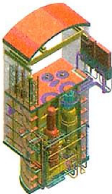
Рис. 7.21. Компонівка модульного гелієвого реактора в будівлі
