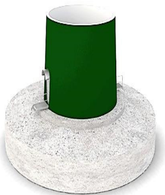
Рис. 4.60. Підстава і фундамент вежі
