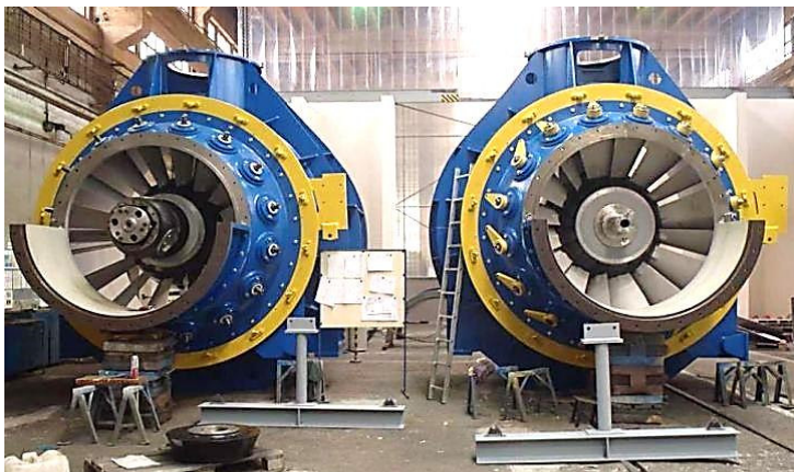
Рис. 5.57. Гідротурбіни типу Kaplan в виробничому цеху MAVEL, http://www.business-consortium.ru/energeticheskoe-oborudovanie/gidroturbiny
