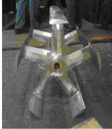
Рис. 5.73. Робоче колесо ортогональної гідротурбіни
