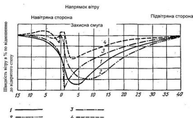
Рис. 4.19. Зростання швидкості вітру після лісової смуги
