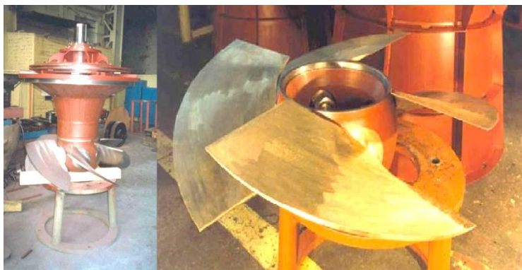
Рис. 5.48. Пропелерна гідротурбіна для малої ГЕС виробництва ВАТ «ІНСЕТ», http://aenergy.com.ua/jelektrosnabzhenie/mini-i-mikro-ges.html
