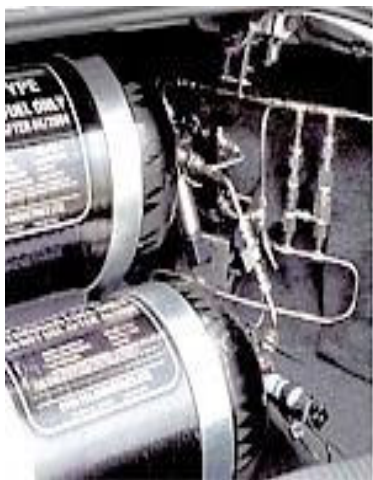
Рис. 7.35. Акумулявання водню в мікрокапілярних контейнерах
