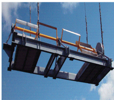
Рис. 5.80. Вільно-потоквова занурена мікроГЕС потужністю 10 кВт, http://www.ideasandmoney.ru/Ppt/Details/27
