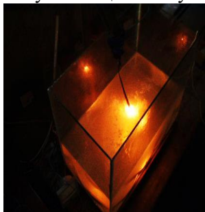
Рис. 7.11. Горіння плазми на кінці вольфрамового електрода
