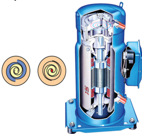
Рис. 3.30. Спіральний компресор теплового насоса:
