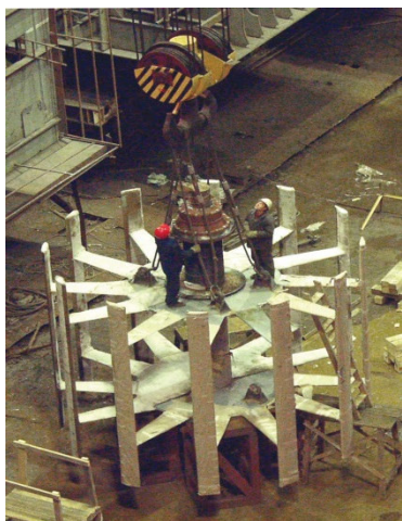
Рис. 5.75. Виготовлення робочого колеса ортогональної турбіни
