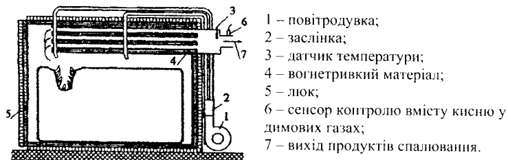
Рис. 5.11. Котел для спалювання великогабаритних тюків соломи
