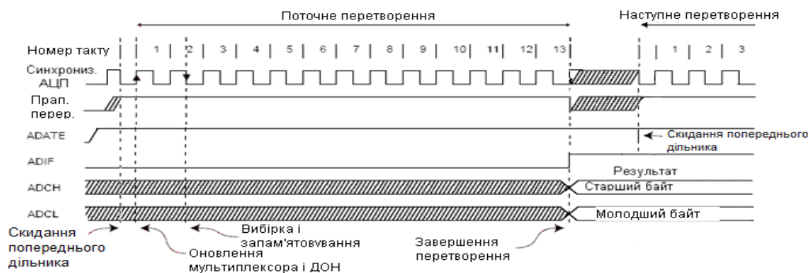
Рис. 7.11. Часові діаграми роботи АЦП у режимі запуску за перериванням
