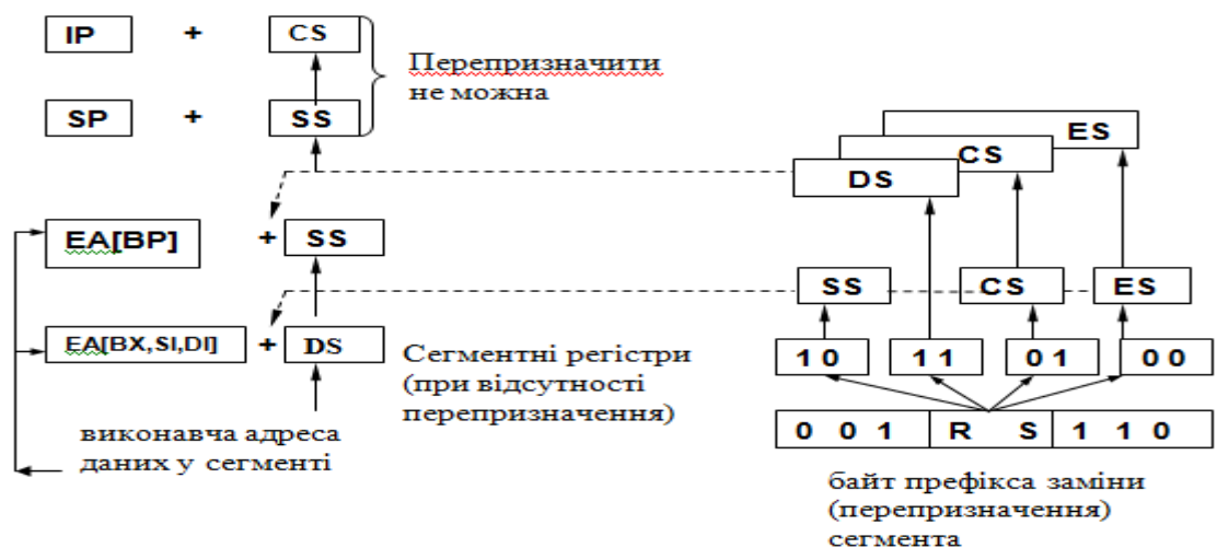
Рис. 2.4. Вибір типу сегмента пам'яті під час обчислення фізичної адреси
