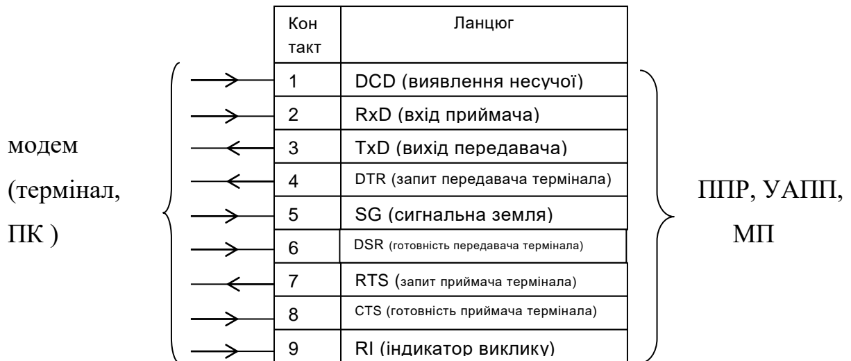
Рис. 8.65. 9-контактний роз'єм RS-232
