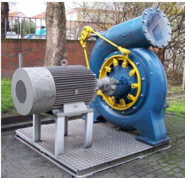
Рис.9.2. Радіально-осьова турбіна з генератором (Francis)
