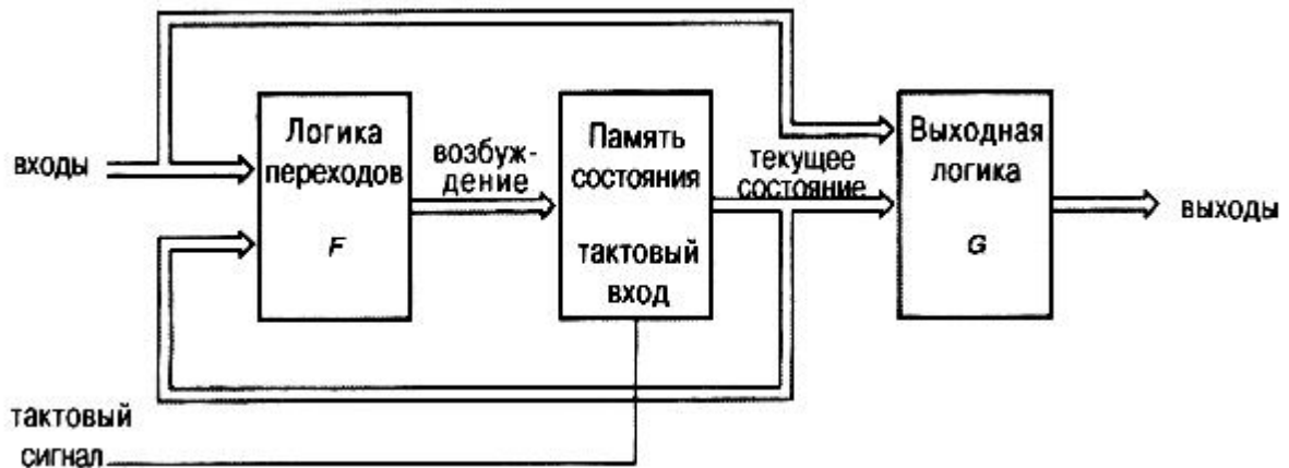
Рис. 24. Структура тактуємого синхронного кінцевого автомата Мілі.
