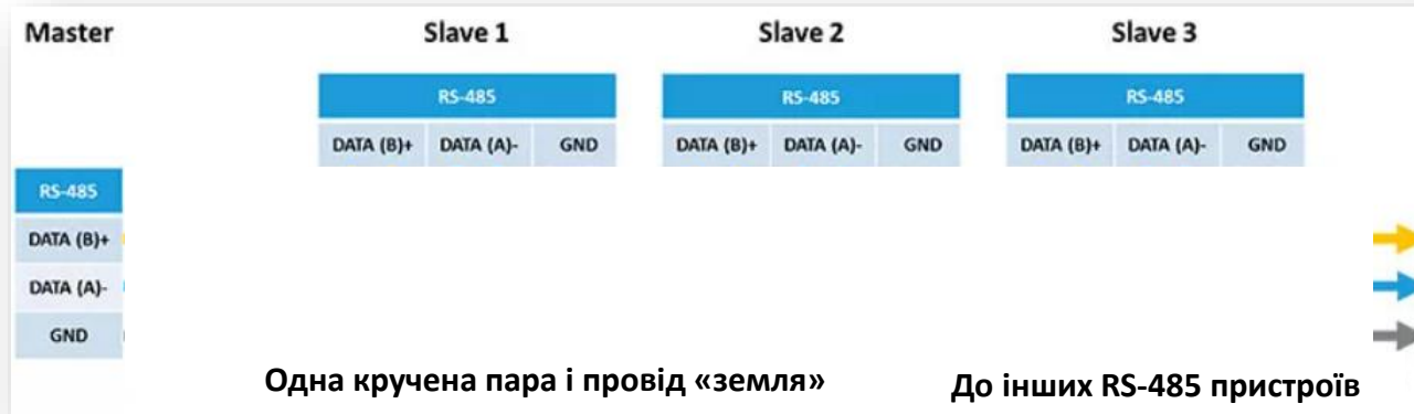
Рисунок 10 – Двохранівідне підключення RS-485
