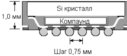
Рисунок 6.7 - Конструкції мікросхем в корпусах типу CSP
