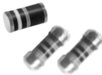
Рисунок 5.4 - Приклад корпусу з безвиводними торцями MELF
