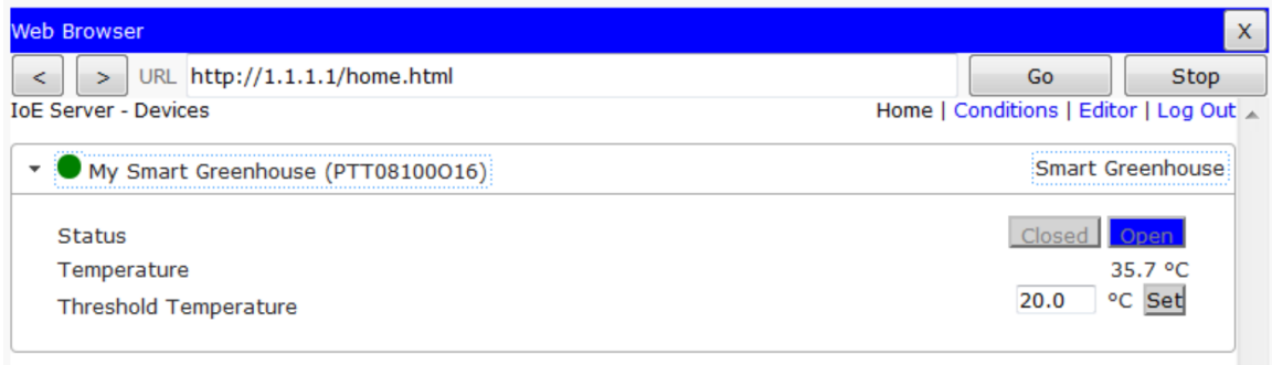
Рис. 1.13. Управління станом температури «розумного пристрою» з веб-браузера
