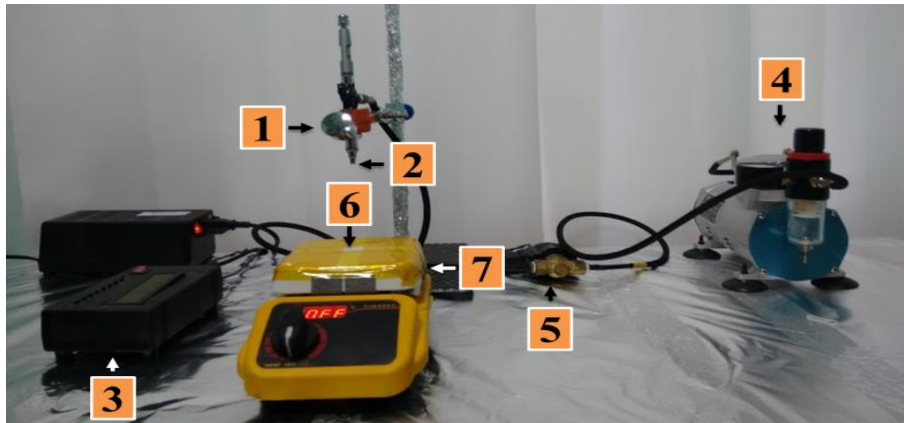
Рисунок 2.5 – Зображення експериментальної установки для нанесення плівок ZnO:Al, SnS методом розпилення чорнил
