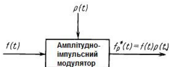
Рисунок 1.13 – Амплітудно-імпульсний модулятор як квантувач: p(t) – несучий сигнал
