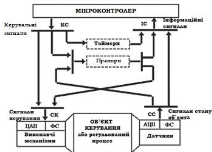
Рисунок 8.2 – Узагальнена структура МК системи керування
