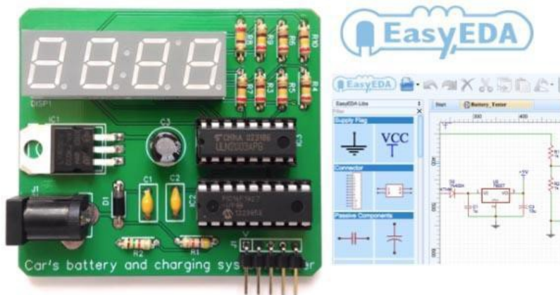
Рисунок 2.1 – EasyEDA дозволяє безкоштовно креслити принципіві схеми, виконувати SPICE-моделювання та проектувати друковані плати
